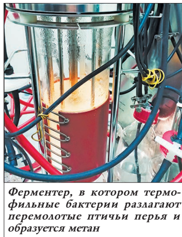
Ферментер, в котором термофильные бактерии разлагают перемолотые птичьи перья и образуется метан
