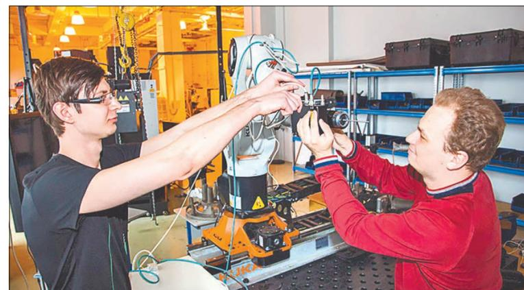
ского зрения и использованию объемной цифровой модели изделий робот сам определяет контуры деталей и при необходимости меняет направление движения рабочих инструментов.
