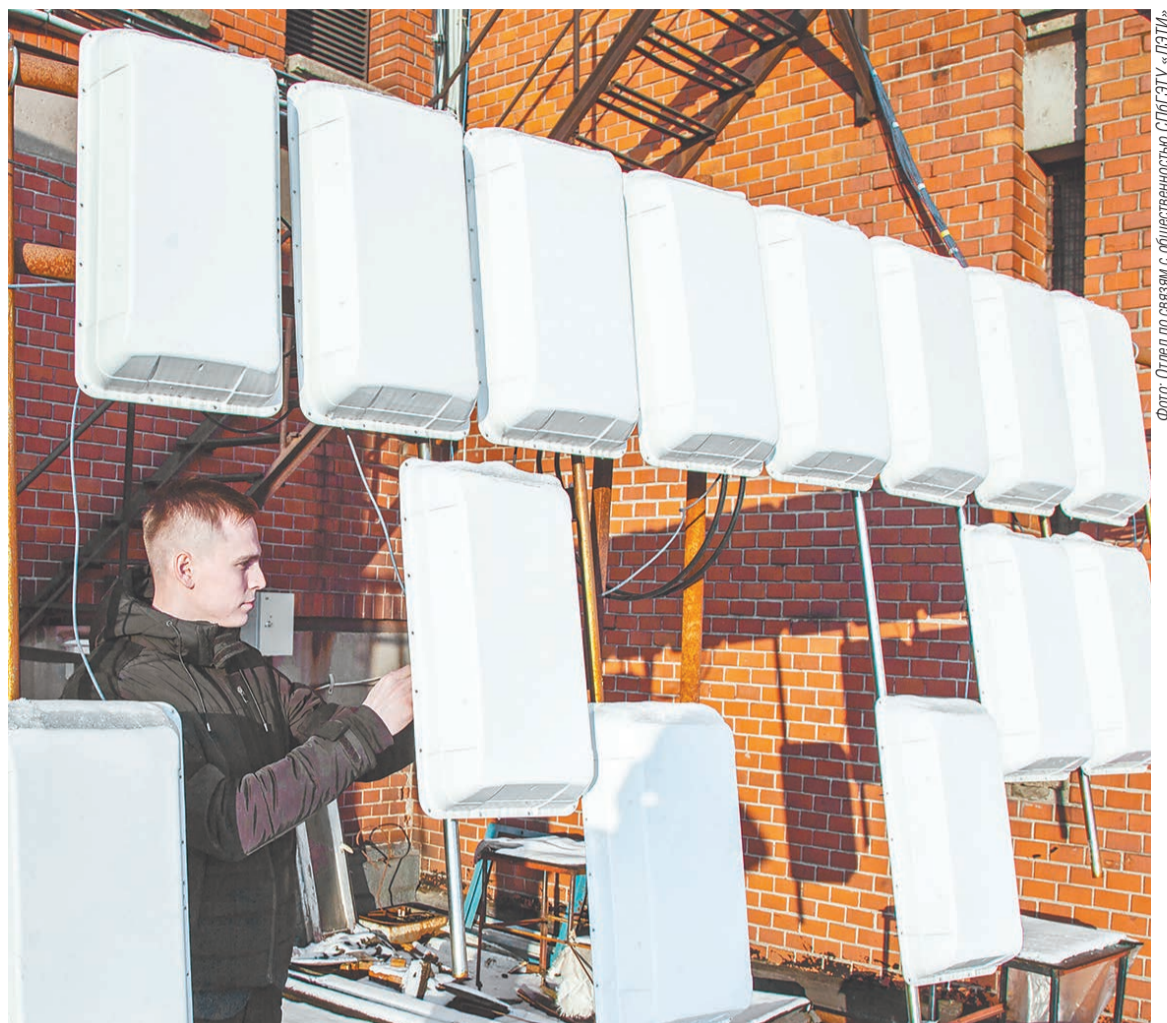
Инженер НИИ «Прогноз» Евгений Воробьев ведет отладку антенной системы пассивного когерентного локатора, размещенной на крыше 5-го корпуса ЛЭТИ
