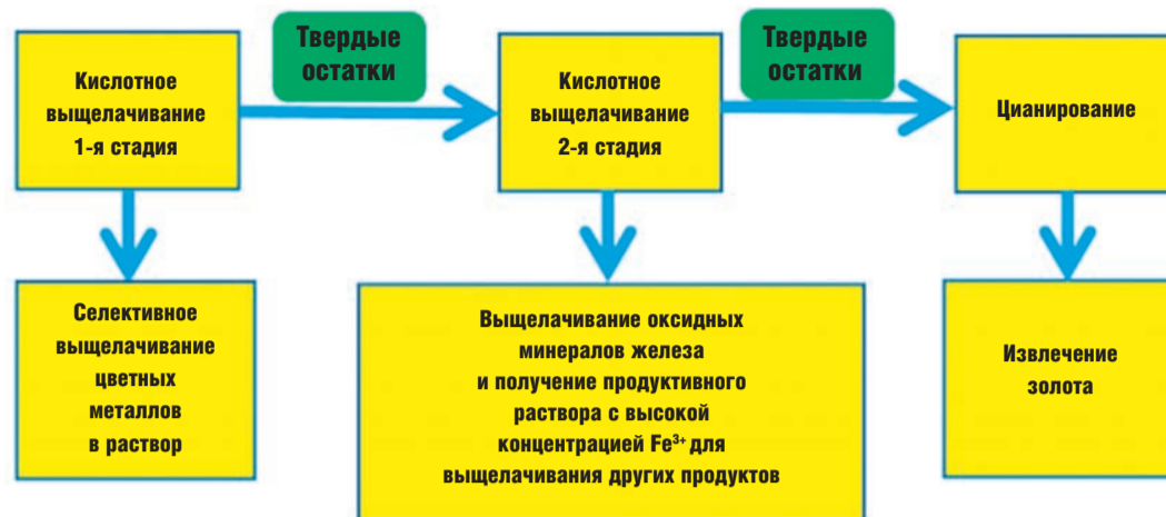
Предлагаемая схема переработки лежалых хвостов флотации с помощью кислотного выщелачивания
