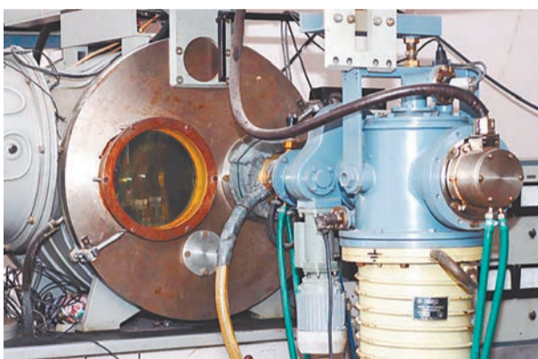
Плазменно-пучковая установка для исследования биологических материалов (МФТИ, Васильева Т.М.).
